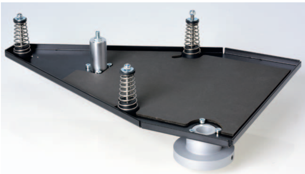
Das schwere Alu-Subchassis ist großzügig bedämpft. Die drei konischen Federn sind gegen Taumeln mit Führungsschrauben versehen und werden, da nicht zentrisch belastet, ungleich stark gespannt. Oben mittig das Tellerlager, dessen Schraube die Gewichtsaufnahme zwischen Kugel und Magnet feinjustiert.
