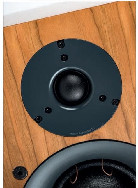
*Auch den Hochtöner baut ATC im eigenen Hause. ATC-Kalotten verfügen über eine doppelte Zentrierung, die Taumelbewegungen und damit einhergehende Verzerrungen verhindert*
