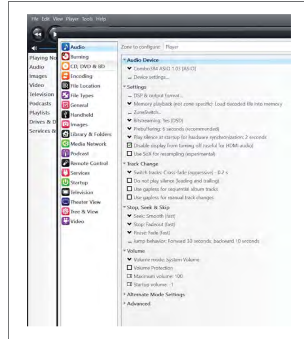
Abb. 11 JRiver MC 22 Einstellungen - Windows: Bei der Wiedergabe von DSD-Dateien sollte "Bitstreaming" auf "Ja(DSD)" eingestellt sein.
