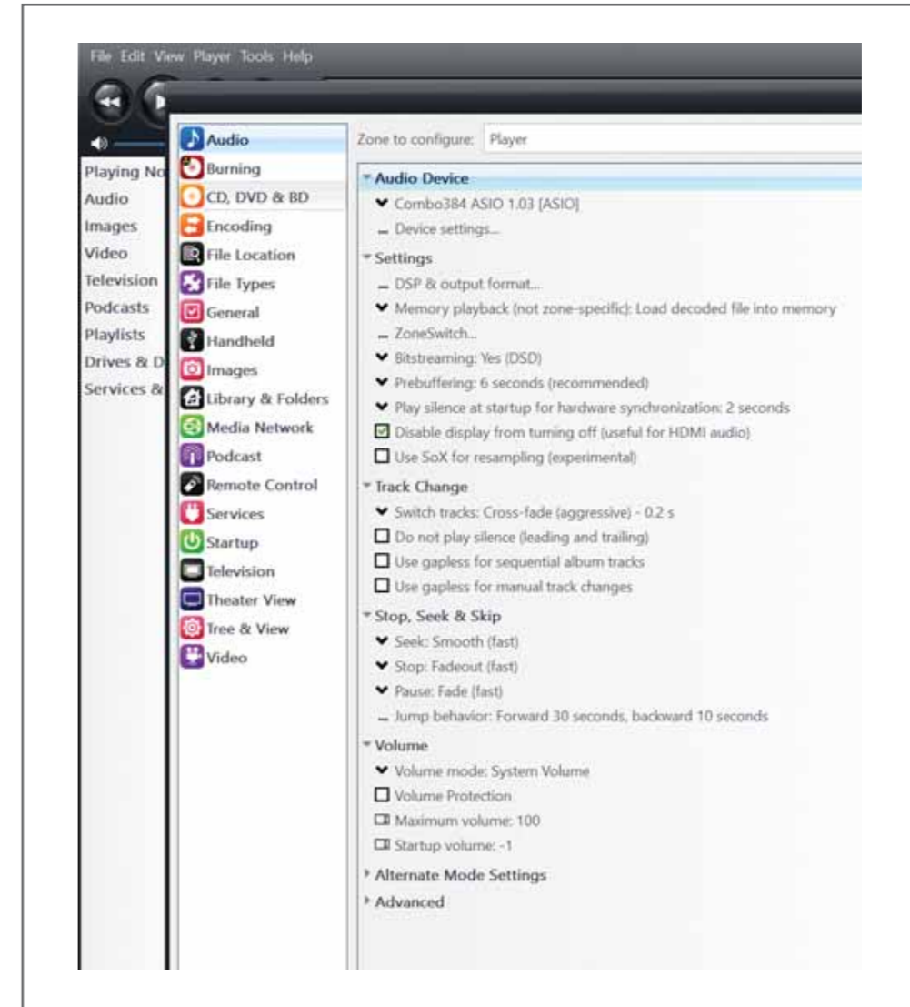
Abb. 8 JRiver MC 22 Einstellungen - Windows: Bei der Wiedergabe von DSD-Dateien sollte "Bitstreaming" auf "Ja(DSD)" eingestellt sein.
