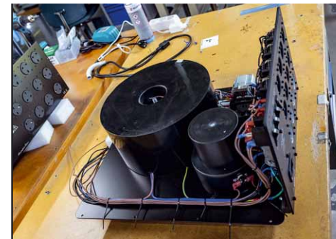
Hier entsteht ein großer Power Conditioner
