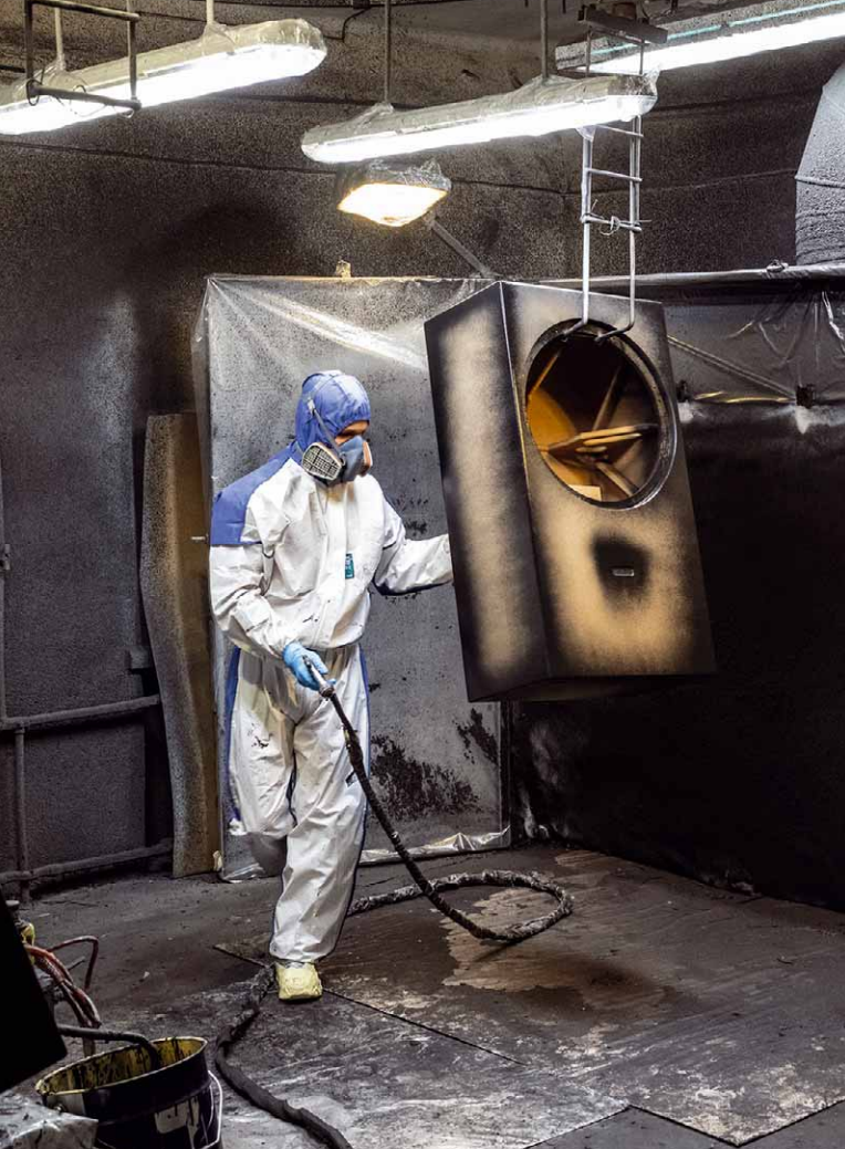
Hier werden Gehäuse für 21"-Subwoofer grundiert
