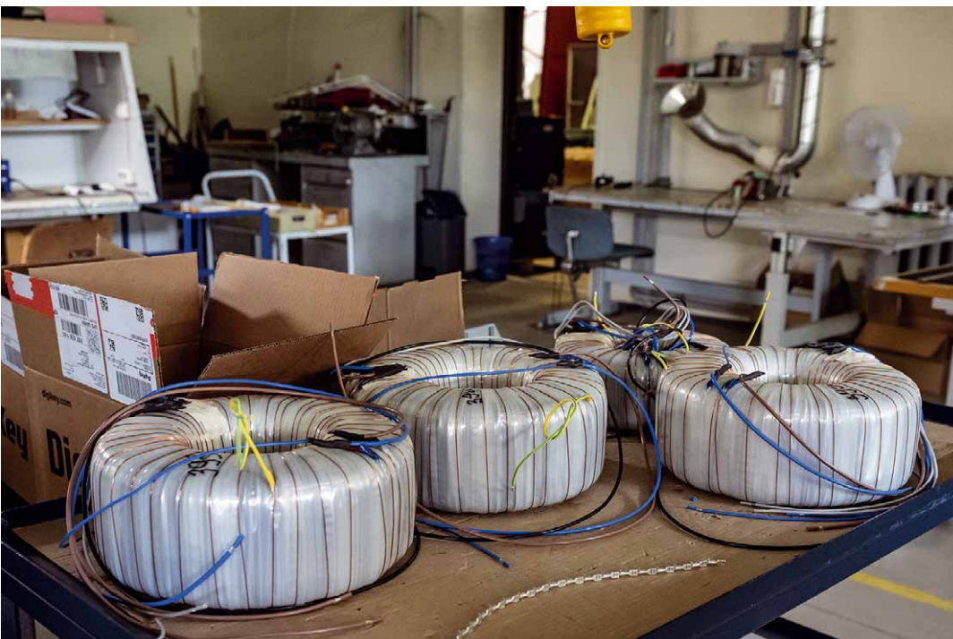
Ein paar größere Ringkerntransformatoren vor dem Verguss
