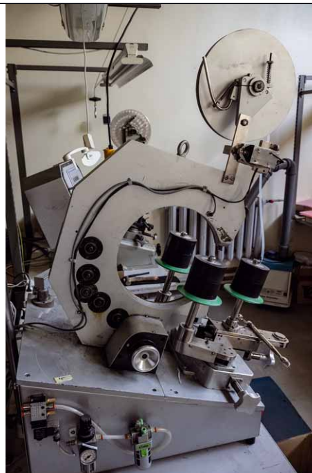
Mit dieser Maschine werden Ringkerne bewickelt, was nämlich gar nicht so einfach ist
