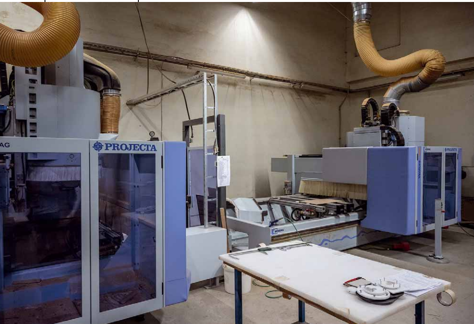
Drei leistungsfähige CNC-Automaten fräsen Einzelteile für Gehäuse
