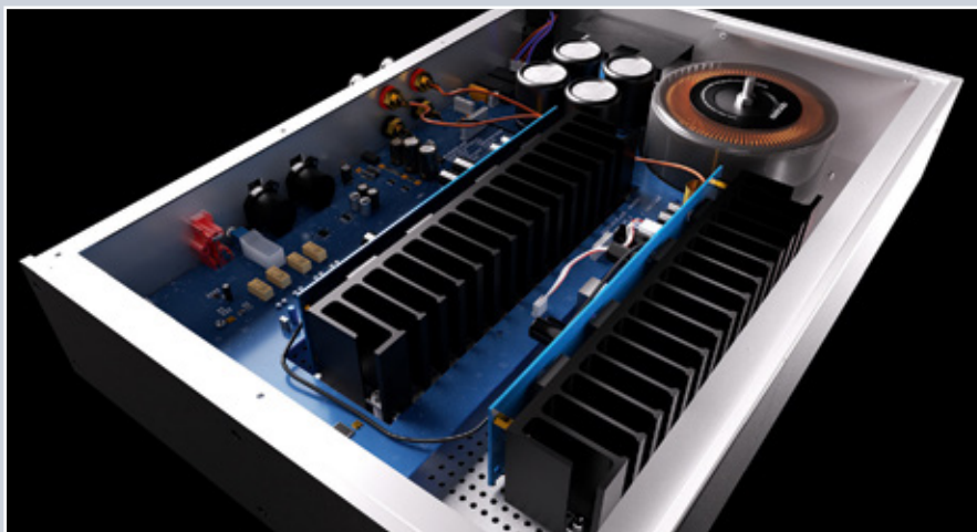
Im Inneren der 9000P kommt die Current-Feedback-Technologie (CFB) zum Tragen, die maßgeblich für die schnelle und präzise Signalverarbeitung der Endstufe verantwortlich ist
