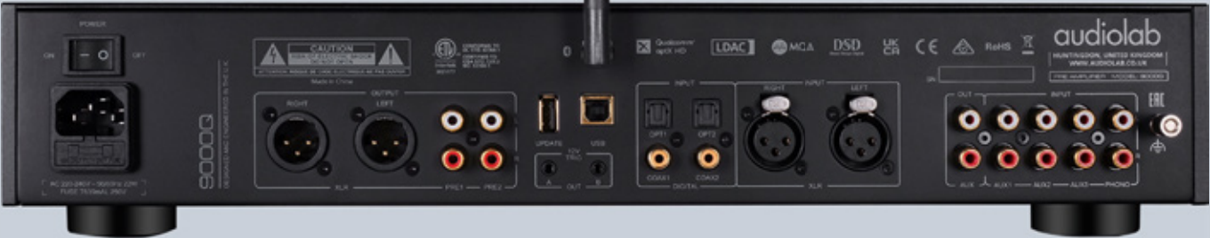
Auf der Rückseite offenbart die 9000Q Vorstufe ihr wahres Talent: drei AUX-Eingänge, ein MM-Phono-Anschluss, zwei digitale Coax- und zwei optische Eingänge sowie ein symmetrischer XLR-Zugang bieten maximale Flexibilität
