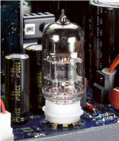
Eine Doppeltriode des Typs 6922 (E88CC) aus russischer Fertigung steuert über MOSFETs die leistungsstarke Halbleiterendstufe an.
