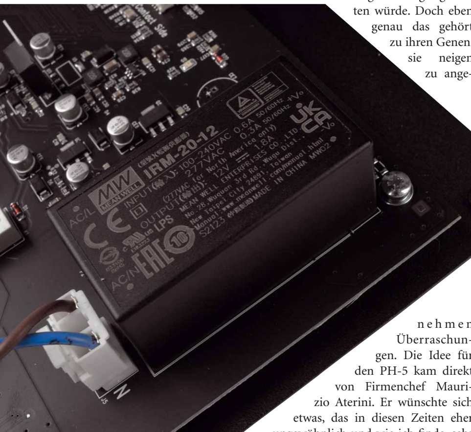
Nicht jedermanns Freund: ein Schaltnetzteil in einer Phonostufe. Hier funktioniert es einwandfrei und macht keine „Schweinerien“
