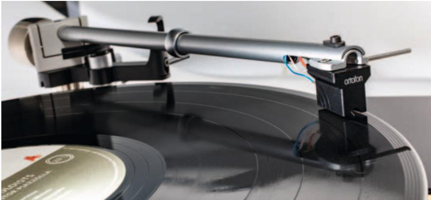
**SCHWARZ UND STARK:** Mit dem Ortofon Quintet Black S bestückt PE den PE 4040 MKII mit einem exzellenten Moving-Coil-Tonabnehmer. Er harmoniert bestens mit dem Arm TP 92.
