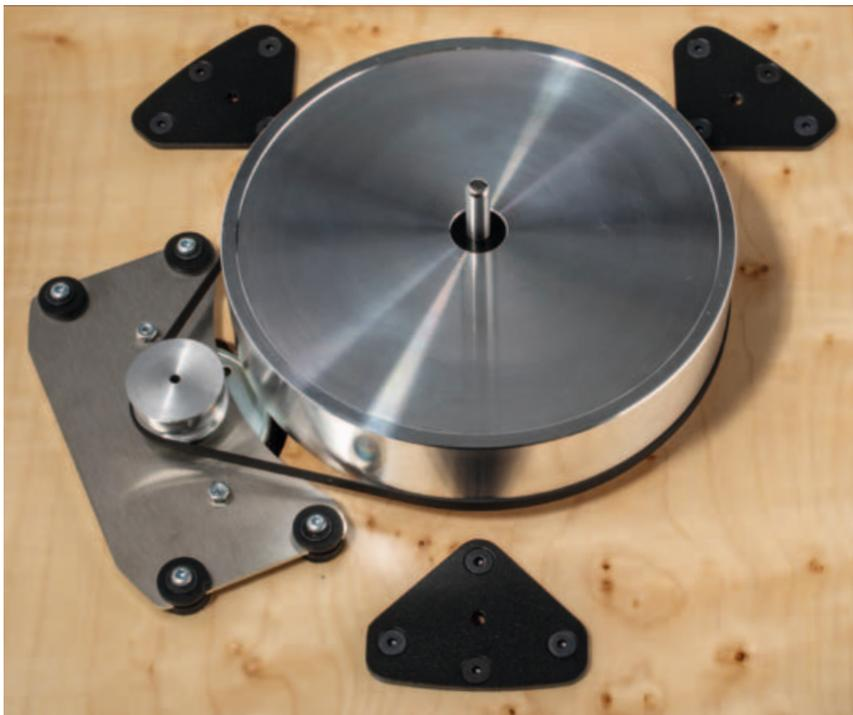
**ANTRIEB UND SICHERHEIT:** Ein geschliffener Flachriemen treibt den Subteller an. Der Motor unter dem Pulley – der Riemen gehört auf seine Mitte – ist wirkungsvoll entkoppelt. Die drei Plastikteile geben den Transport-Sicherungsschrauben für das Subchassis Halt.
