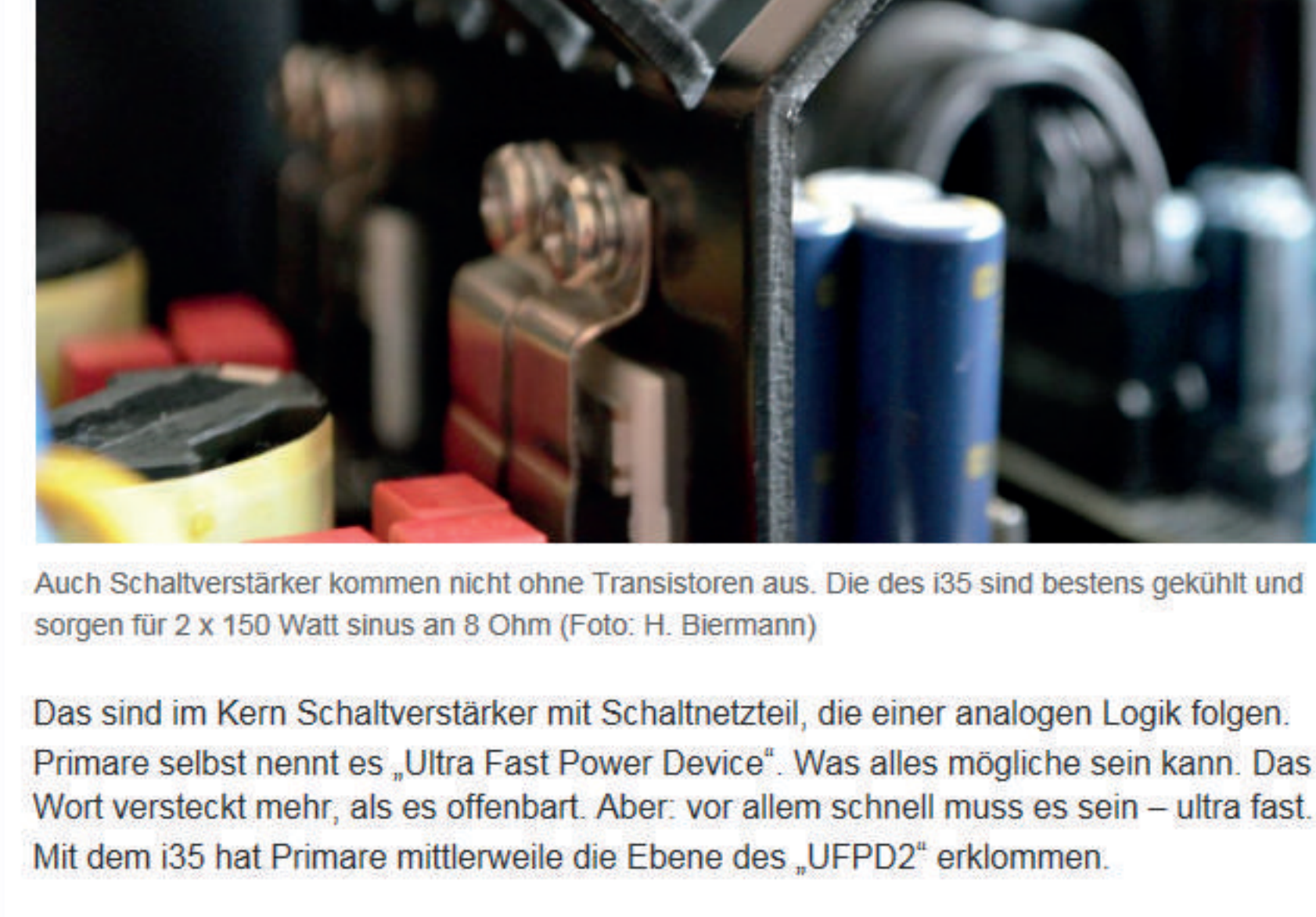
Auch Schaltverstärker kommen nicht ohne Transistoren aus. Die des i35 sind bestens gekühlt und sorgen für 2 x 150 Watt sinus an 8 Ohm (Foto: H. Biermann)
