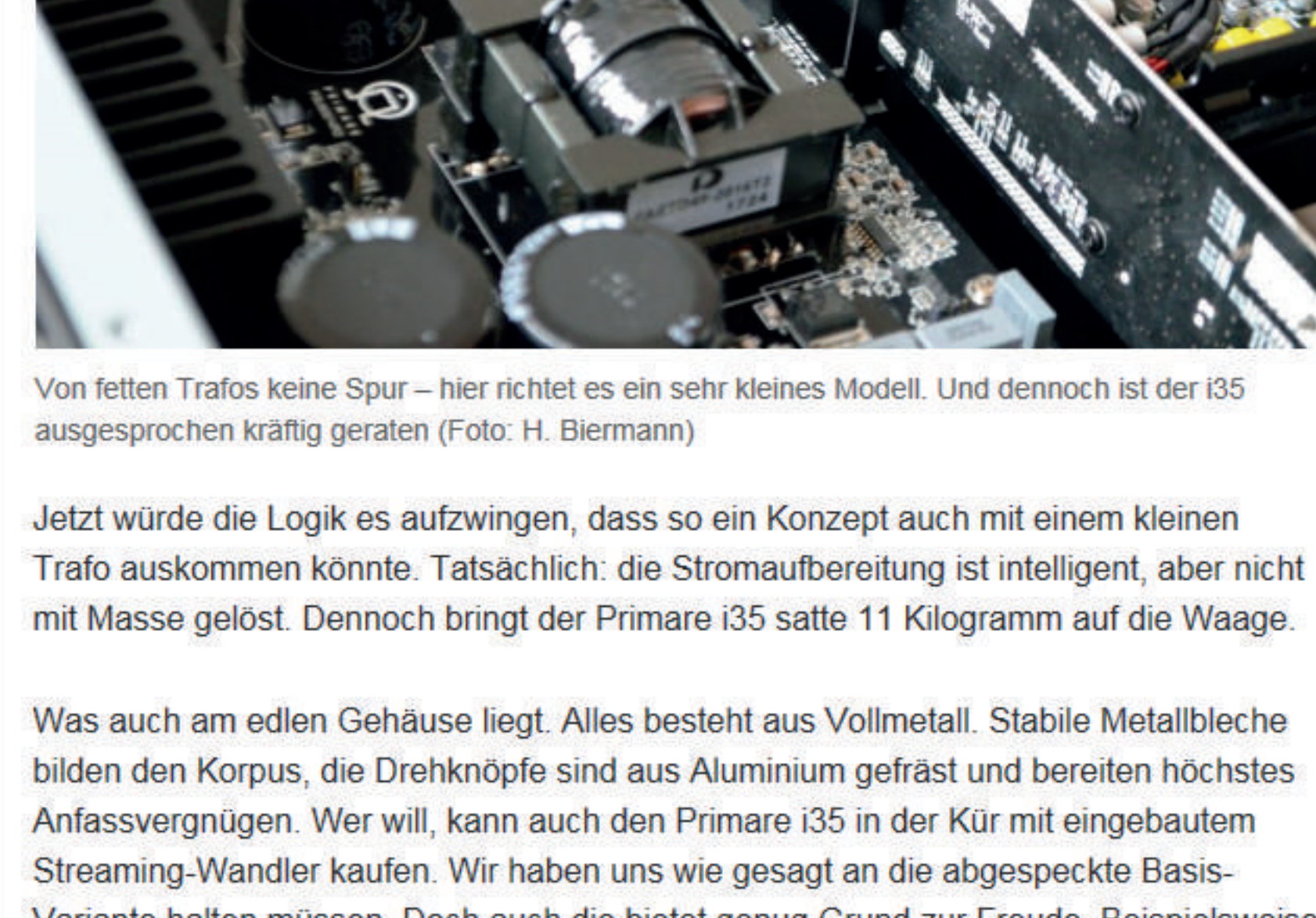
Von fetten Trafos keine Spur – hier richtet es ein sehr kleines Modell. Und dennoch ist der i35 ausgesprochen kräftig geraten (Foto: H. Biermann)
