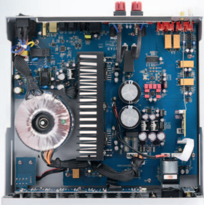
Hinter dem Ringkerntrafo sitzt die Digitalfraktion, hinten rechts nimmt der Vena II analoge Signale einschließlich Phono-MM entgegen.
