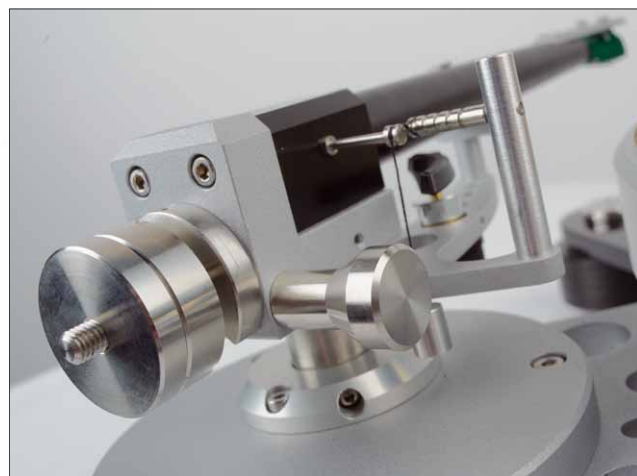
Drei individuell verschiebbare Gegengewichte und die seitlichen Stahlausleger verleihen dem Tonarm zusätzliche Stabilität
