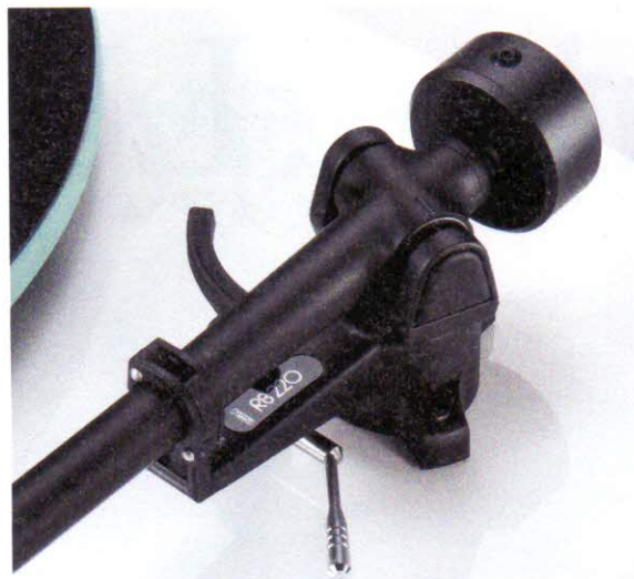
Das Gegengewicht hat keine Skala. Einmal ganz rum entspricht exakt 20 Millinewton. Die Antiskating zieht den geraden Arm mit voreingestellter Kraft nach außen.
