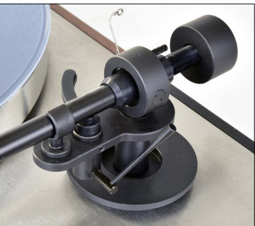
◀ STARKER EIGENBAU: Den Tonarm PE TO 2017 fertigt Perpetuum Ebner selber. An dem kardanisch gelagerten 9-Zöller mit Alurohr sorgt ein Fadengewicht für das Antiskating.
