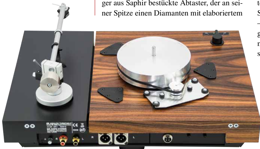
Der über einen Flachriemen angetriebene Subteller sitzt wie der Tonarm auf einem federnd gelagerten Innenchassis. Der Motor ist mit der Zarge verbunden. Die MKII-Version des PE4040 bietet neben den Cinch- auch XLR-Ausgänge für den symmetrischen Betrieb.
