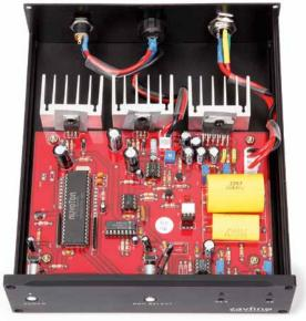
Das externe Netz- und Steuerteil besticht mit hochwertigen Bauteilen. Auf kleine Kühlkörper montierte Transistoren garantieren Stabilität.
