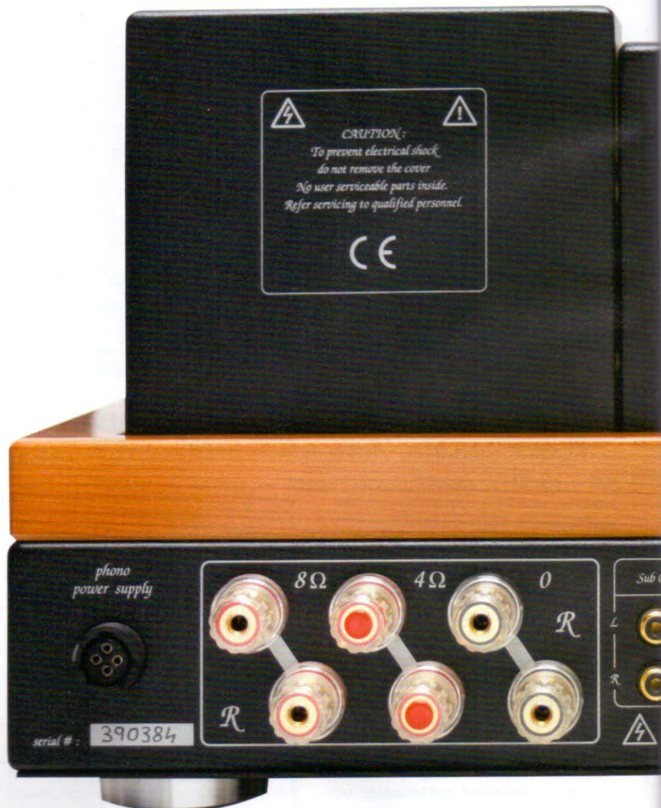
Anschlussfeld des Unison Research Sinfonia. Hier stehen Anschlüsse für 8-Ohm- und für 4-Ohm-Boxen zur Verfügung
