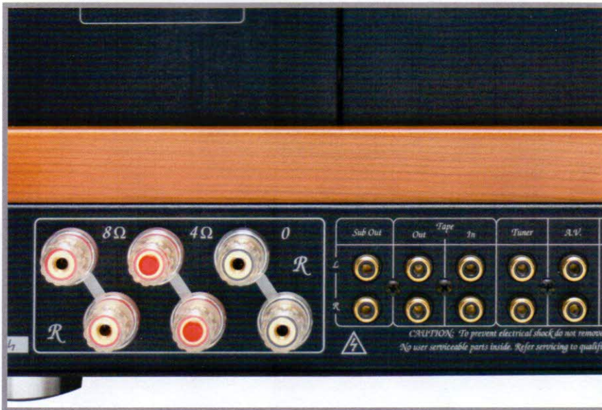
Die Lautsprecherklemmen sind mehrfach ausgelegt. Damit ist der Bi-Wiring-Betrieb möglich. Zwei Pluspole unterscheiden zw. 4-Ohm- und 8-Ohm-Lautsprechern
