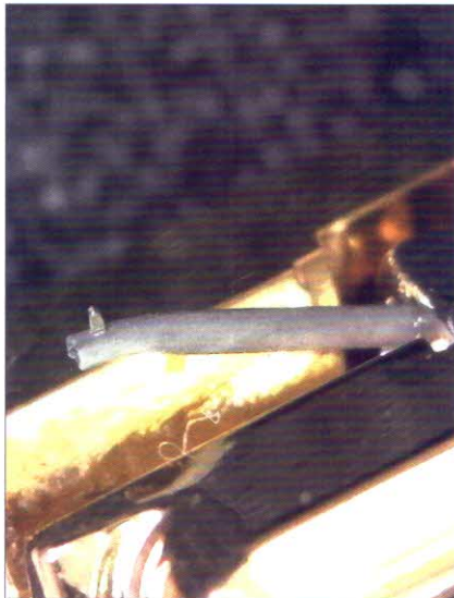
Die Excalibur-Tonabnehmer setzen beim Nadelträger auf leichtes Aluminium
