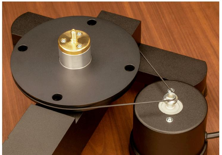
Die schwere Motordose steht separat hinter dem Chassis und treibt den Subteller über einen dünnen Rundriemen an. So haben Motorvibrationen kaum eine Chance bis zur Nadel vorzudringen.
