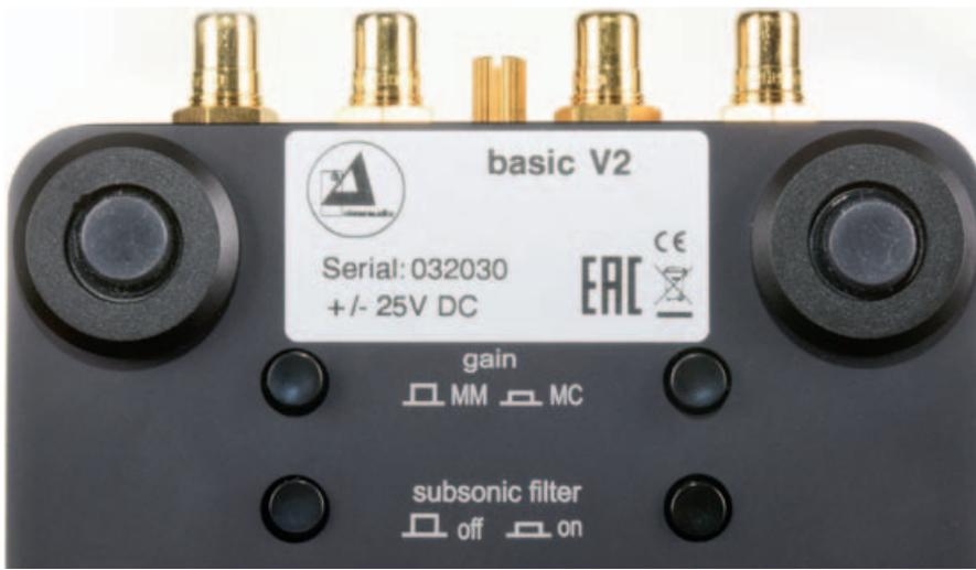
**NIMM ZWEI:** Dem kanalgetrennten Innenaufbau ist es geschuldet, dass man sowohl MM/MC als auch das Subsonic-Filter an der Unterseite separat für links und rechts drücken muss.
