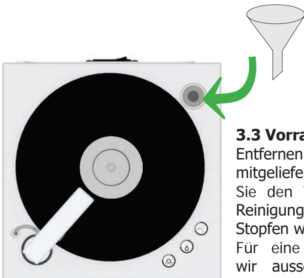
Abb. 2: Befüllen des Vorratsbehälter
