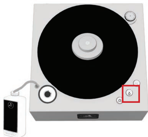
Pic. 11: Entleeren des Vorratsbehälters
