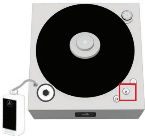
Abb. 11: Entleeren des Vorratsbehälters
