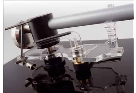
Am einpunktgelagerten Tonarm kann man gut die stabilisierenden Maßnahmen erkennen: Das Gegengewicht ist außermittig gebohrt und der zentrale Massezylinder wird sehr weit nach unten gezogen
