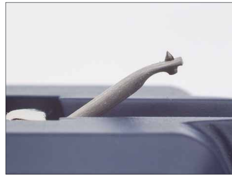
Beim Blue kommt ein künstlicher Diamant mit elliptischem Schliff zum Einsatz
