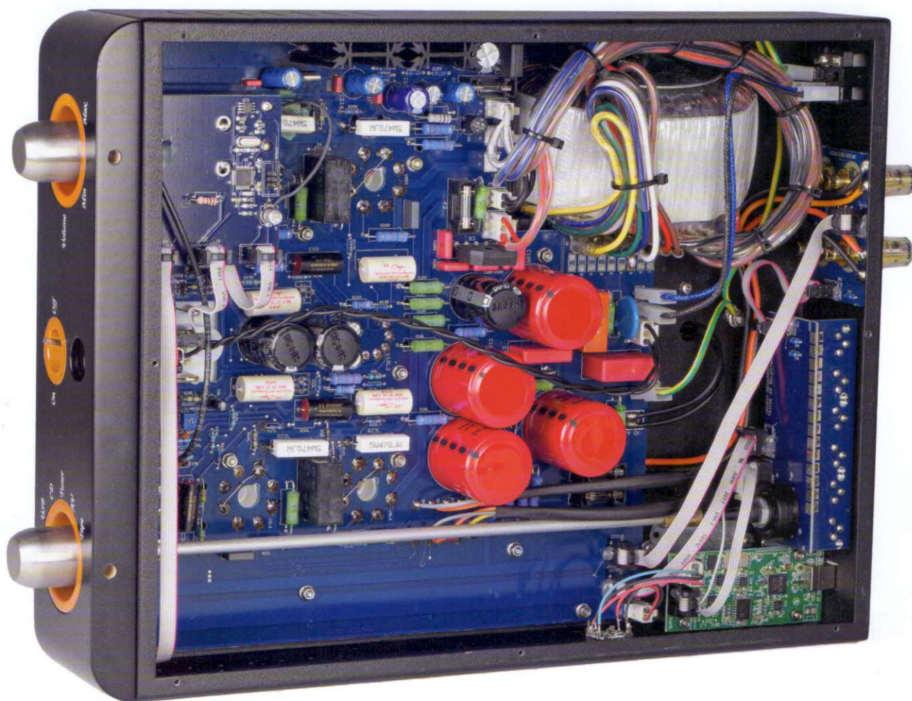
Ein sehr großzügig bemessener Ringkerntrafo speist eine saubere Schaltung mit qualitativ hochwertigen Bauteilen. Rechts unten liegt die optionale DAC-Platine. Typisch Unison: Über eine lange Welle werden die Eingänge geschaltet.
