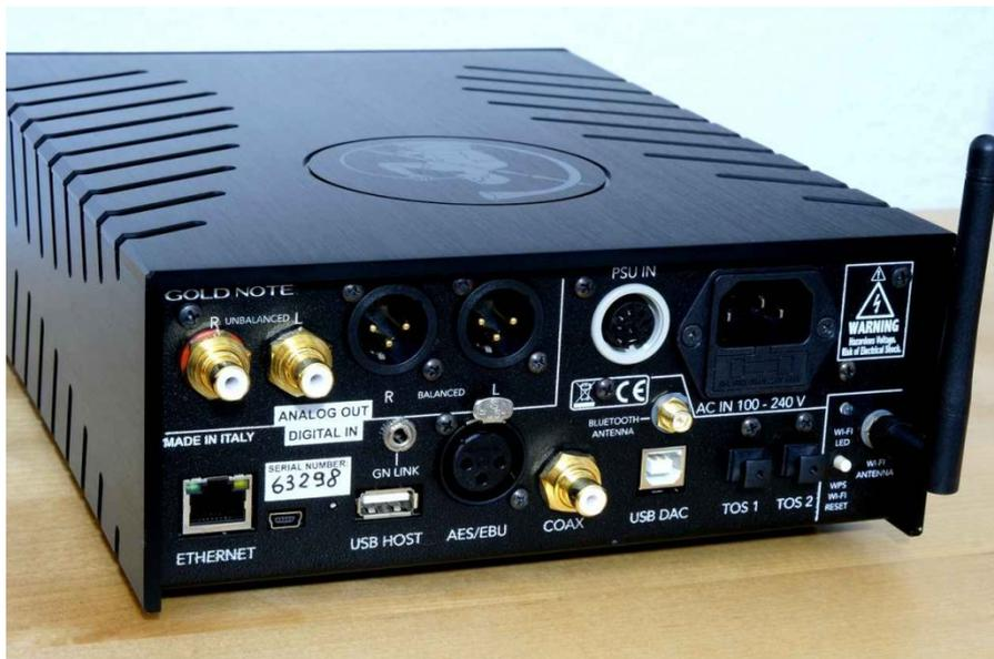
Rückseitig auf dem Gold Note DS-10 gibt es dann eine ordentliche Phalanx an Anschlüssen, lediglich einen analogen Eingang zum Beispiel für den Anschluss des Phonoverstärker Gold Note PH-10 habe ich vermisst. Hier die Eingänge des DS-10 sowie deren technischen Daten:
