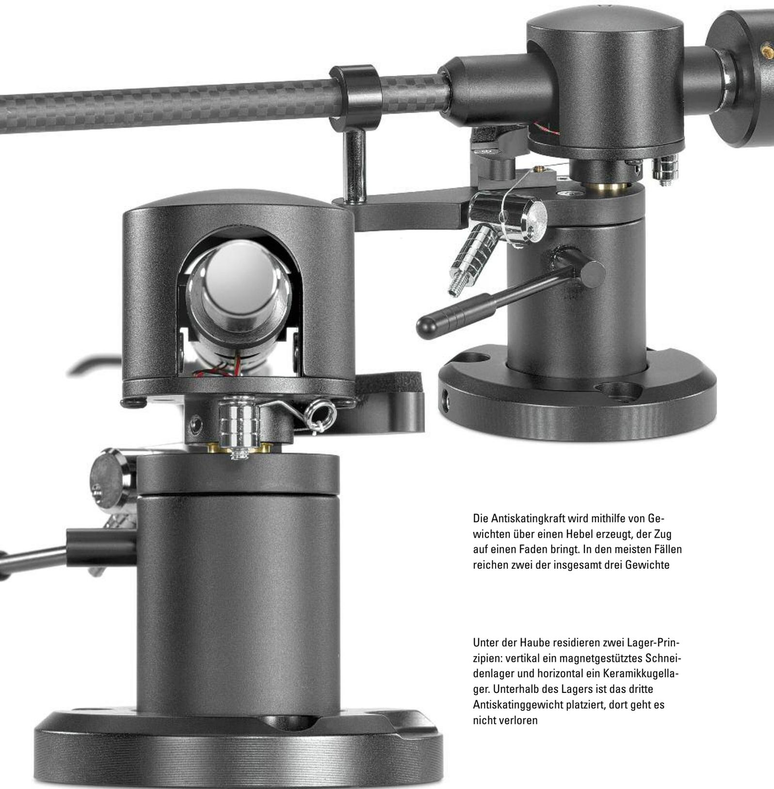
Die Antiskatingkraft wird mithilfe von Gewichten über einen Hebel erzeugt, der den Zug auf einen Faden bringt. In den meisten Fällen reichen zwei der insgesamt drei Gewichte
