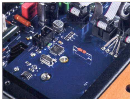
Ohne Computer geht's auch hier nicht: Ein Mikrocontroller übernimmt Steuerungsfunktionen
