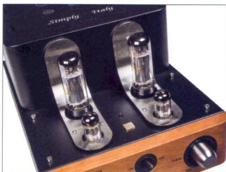
Das Gerät arbeitet mit einer EL34 und einer ECC82 aus russischer Fertigung pro Kanal
