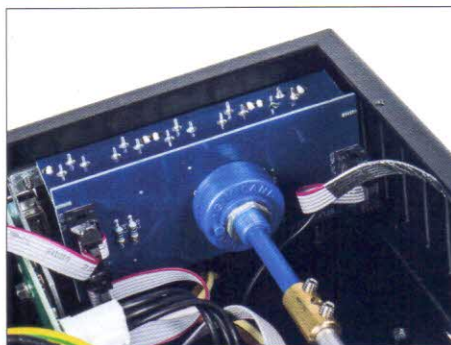
Solide: Eingangswahl mit Drehschalter direkt vor Ort, das gibt kurze Signalwege
