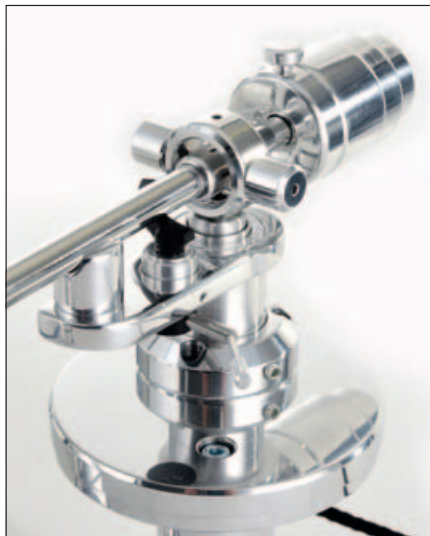
AUSGEKLÜGELT: Das Tonarmlager mit auf jeder Seite 15 Präzisionskugeln in der Hülse.
