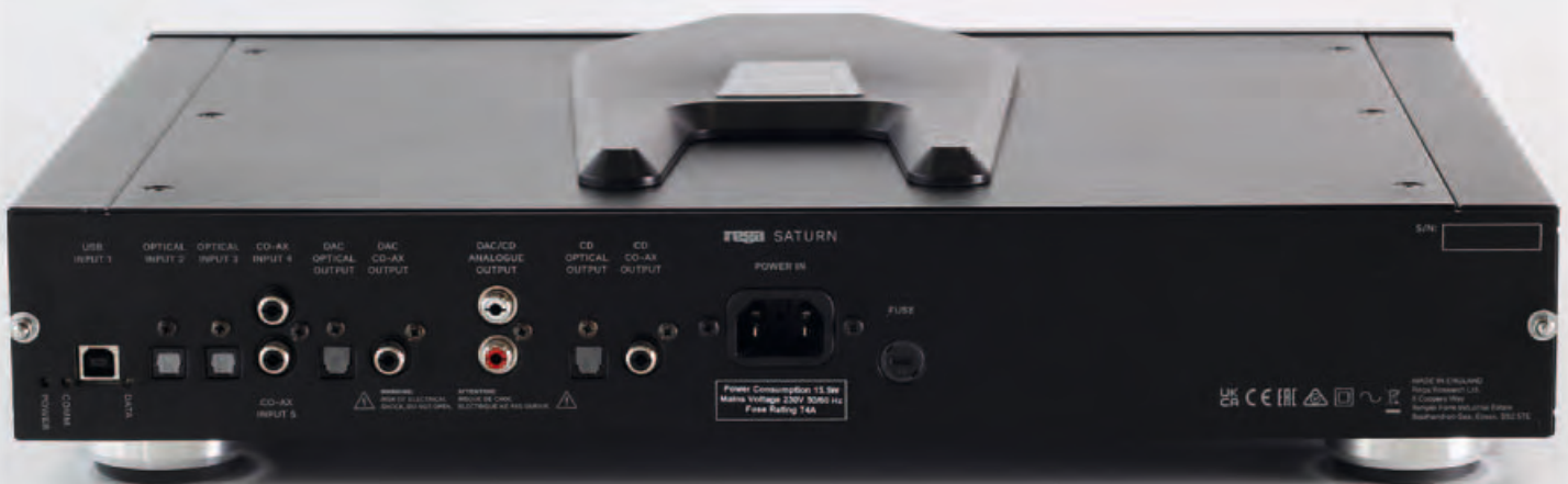
EIN- UND AUSSTIEG: Die Rückseite zeigt die digitalen Eingänge für den DA-Wandler: USB-B (von links), jeweils zwei optisch und Coax, die digitalen Ausgänge des DAC (optisch, Coax), die analogen Cinch-Ausgänge, die digitalen Ausgänge des Laufwerks (optisch, Coax).
