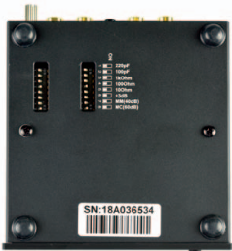
Phono Box S2 Ultra: Durch den +3dB-Schalter bietet die Ultra vier Verstärkungsfaktoren.
