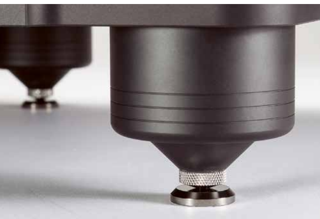
Drei solide Aluminiumzylinder tragen den Copperhead-X. Fixierbare Kupfer-Spikes erlauben den Niveaueausgleich. Die Schoner sind aus Stahl.
