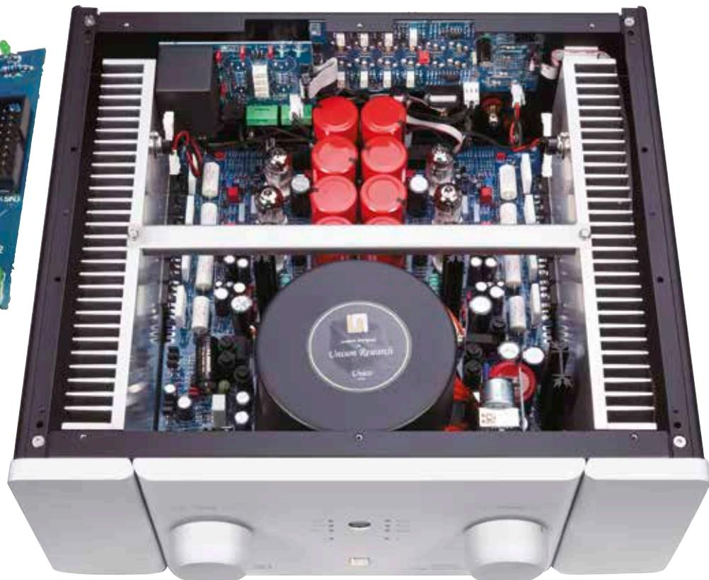
Der Ringkerntrafo samt Siebung ist offensichtlich satt überdimensioniert. ▶
